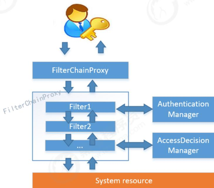
FilterChainProxy是一个代理，真正起作用的是FilterChainProxy中SecurityFilterChain所包含的各个Filter，同时这些Filter作为Bean被Spring管理，它们是Spring Security核心，各有各的职责，但他们并不直接处理用户的认证，也不直接处理用户的授权，而是把它们交给了认证管理器（AuthenticationManager）和决策管理器（AccessDecisionManager）进行处理，下图是FilterChainProxy相关类的UML图示。
