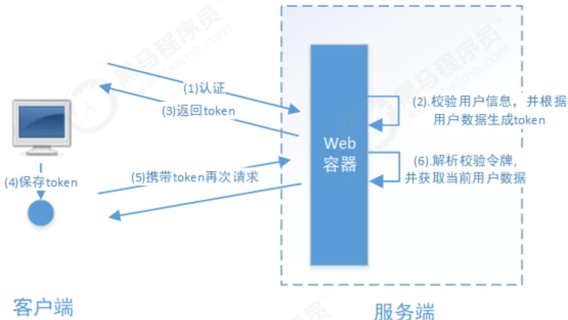
基于session的认证方式由Servlet规范定制，服务端要存储session信息需要占用内存资源，客户端需要支持cookie；基于token的方式则一般不需要服务端存储token，并且不限制客户端的存储方式。如今移动互联网时代更多类型的客户端需要接入系统，系统多是采用前后端分离的架构进行实现，所以基于token的方式更适合。
